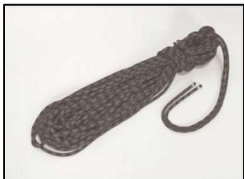
**Kernmantel-Dynamikseil:** wird zur Sicherung in absturzgefährdeten Bereichen verwendet / es muss: einen Durchmesser zwischen 9,1mm – 11 mm haben und maximal 10% Seildehnung aufweisen
