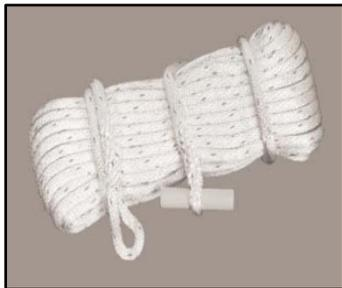
**Feuerwehrleine:** dient als Rettungs-, Sicherungs- und Signalleine / sie muss: einmal jährlich geprüft werden, aus Polyesterfasern bestehen, weiß sein, 30m lang sein und einen Durchmesser von 10mm haben
